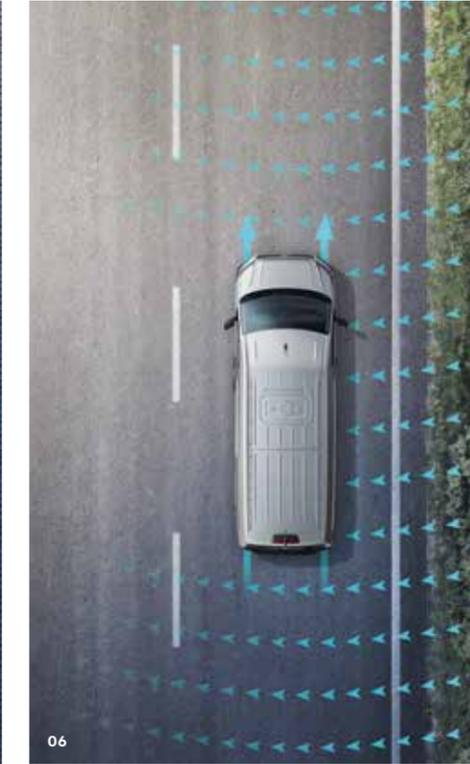
**06 Seitenwindassistent.<sup>1)</sup>** Unterstützt als Teilfunktion des elektronischen Stabilisierungsprogramms bei starkem, böigem Seitenwind durch automatische Bremsengriffe an den Rädern.
