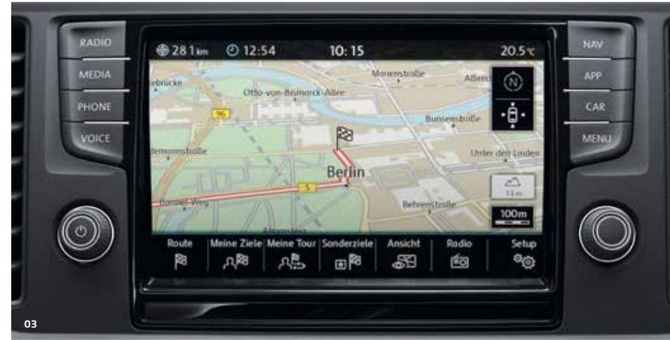
**03 Navigationssystem „Discover Media“.** Das Car-Net Guide & Inform sowie App-Connect fähige System umfasst ein 20,3 cm (8,0 Zoll) großes TFT-Farbdisplay, einen Touchscreen mit Annäherungssensoren, ein MP3-fähiges CD-Laufwerk, 4 x 20 Watt Leistung mit vier Lautsprechern, eine Bluetooth-Anbindung, einen Doppeltuner mit Phasen-Diversity, eine AUX-IN-, eine USB- und zwei SD-Schnittstellen im Handschuhfach sowie eine SD-Karte mit Kartenmaterial.
