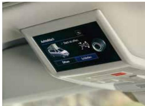
Steuerung des elektrohydraulischen Aufstelldachs<sup>1)</sup>
